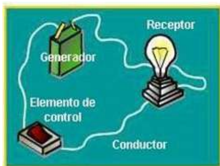
Imagen nº 7. Circuito eléctrico Fuente: JCCM
