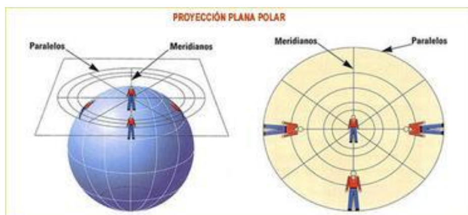
Imagen 12: Proyección azimutal y su distorsión
