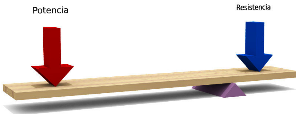
Imagen 24: Palanca de primer grado. URL: https://es.wikipedia.org/wiki/Operadores_mec%C3%A1nicos#/media/File:Palanca-tipo1.jpg
