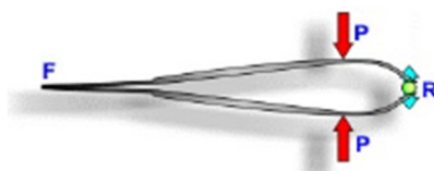
Imagen 30: Palanca tercer grado. Materiales Virtuales LOE
